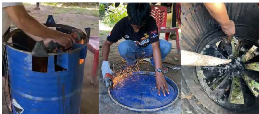
Gambar 4 . Pembuatan ventilasi untuk bagian bawah drum didalam
