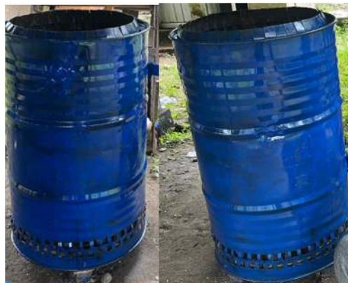
Gambar 6 . Pembuatan ventilasi bagian bawah drum di bagian luar
