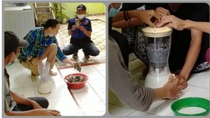
Gambar 10. Proses blending bahan kertas menggunakan mesin blender rumah-tangga
