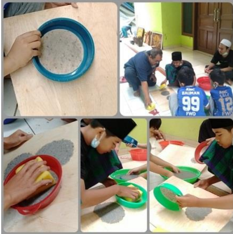
Gambar 12. Proses mencetak, menempel, menyerap air, mengangkat saringan
