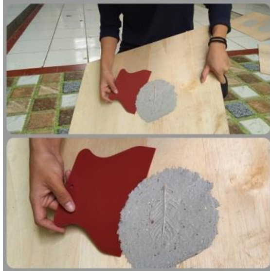
Gambar 14. Mengelupas kertas yang telah kering—menggunakan alat kape.
