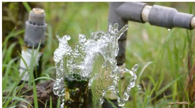
Gambar 4. Air yang terbuang di hydraulic ram pump [14]
