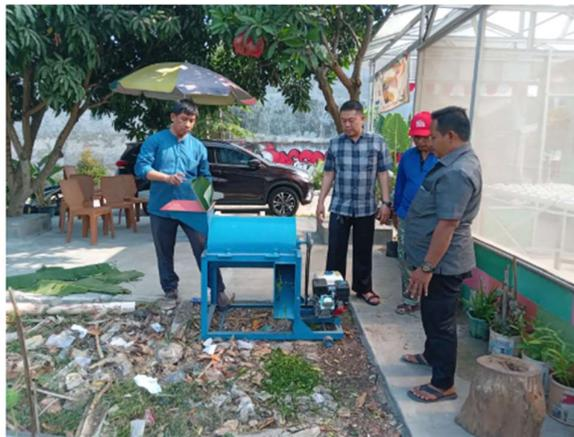
[Gambar 5](#). Pengujian alat pencacah sampah organik
