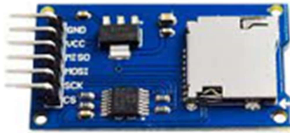
Gambar 2. Micro SD module [6]
