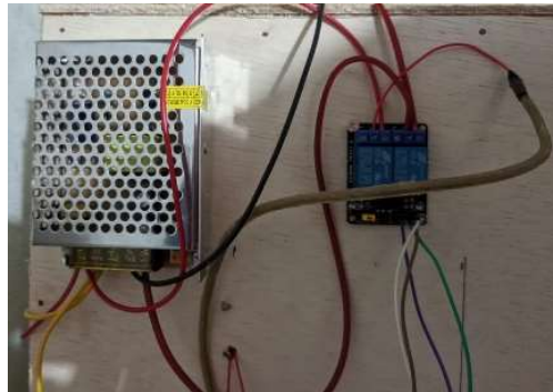
Gambar 5. Menjelaskan rangkaian di relay dan power supply
