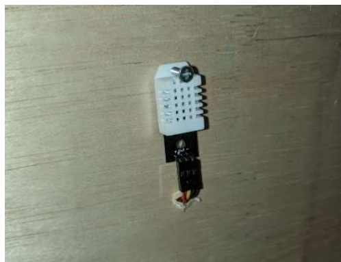
Gambar 6. Menjelaskan Sensor DHT22
