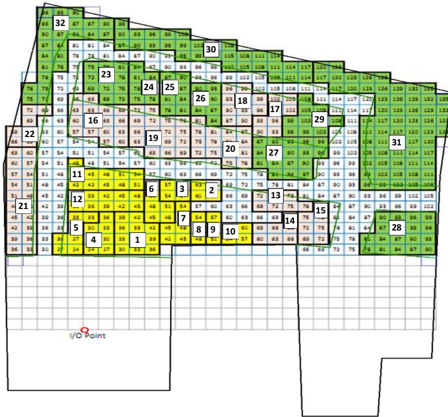
Gambar 3. Usulan tata letak penyimpanan produk di gudang PT. XYZ beserta nilai lokasi Gambar 3 menunjukkan bahwa hasil penyebaran lokasi penyimpanan produk yang diusulkan, ditandai dengan warna yang tersusun secara berkelompok. Warna kuning menunjukkan item produk klasifikasi kelas A dengan frekuensi keluar masuk produk yang cepat, warna merah muda merupakan item produk klasifikasi kelas B yaitu produk dengan frekuensi keluar dan masuknya barang yang termasuk pada kelompok sedang, sedangkan warna hijau merupakan klasifikasi kelas C dengan frekuensi keluar dan masuknya produk kelompok yang lambat. Gambar 3 merupakan layout usulan tata letak gudang yang baru, selanjutnya dilakukan perhitungan kembali menggunakan metode rectilinear ( Tabel 1 ), untuk mendapatkan nilai perhitungan total jarak perpindahan berdasarkan tata letak awal dan tata letak usulan. Hasil analisa kemudian dikalikan dengan jumlah produk untuk mendapatkan nilai jarak perpindahan produk rata-rata lokasi blok penyimpanan produk yang baru terhadap lokasi titik I/O selama periode waktu pengamatan penelitian. Adapun perhitungan jarak perpindahan untuk produk Shoring 0.5 m - WKC berdasarkan tata letak awal dan tata letak usulan adalah sebagai berikut:
