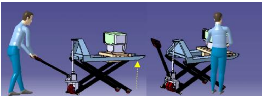
Gambar 8. Simulasi pada kegiatan peletakan mesin diesel (Sumber: CATIA V5)
