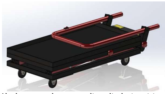
Gambar 4 . Alat bantu pembuatan medium disolusi posisi meja di bawah
