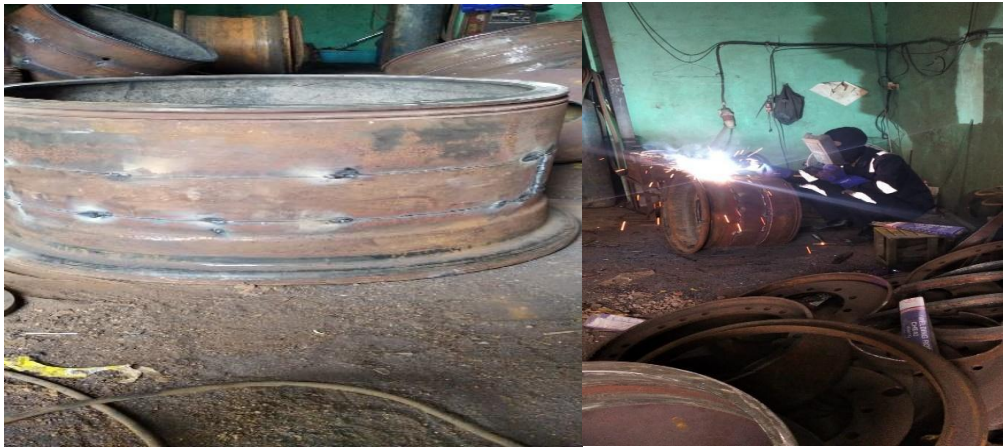
Gambar 7. Body velg tambahan pipa dan welding.
