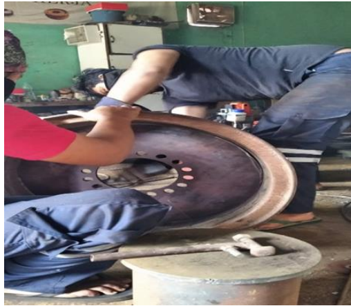
Gambar 11. Penyetingan penempatan kepala ke body velg.
