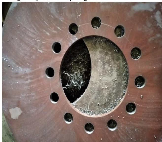
Gambar 10. Contoh lubang baut pada kepala velg.
