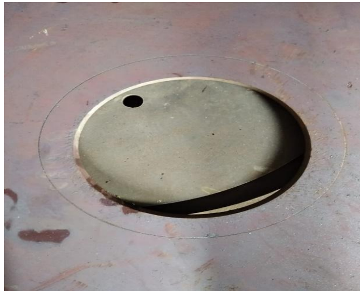
Gambar 8. Bubutan NAP & goresan VCD.
