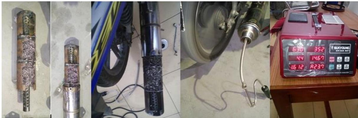
Gambar 3. Pengujian dengan alat gas analyzer pada knalpot rekayasa yang ditambahkan skrap besi ST-40 seberat 50 gr, 70 gr, dan 90 gr.
