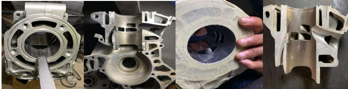
Gambar 4. Pengukuran lubang dan proses porting
