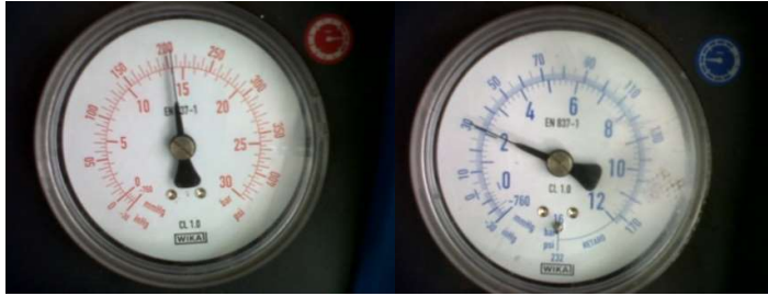
Gambar 8. Hasil pengukuran tekanan refrigerant dalam kondisi normal
