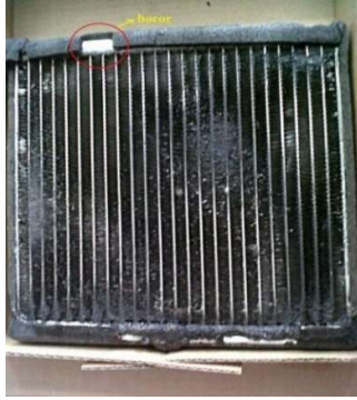
Gambar 3. Evaporator yang mengalami kerusakan.
