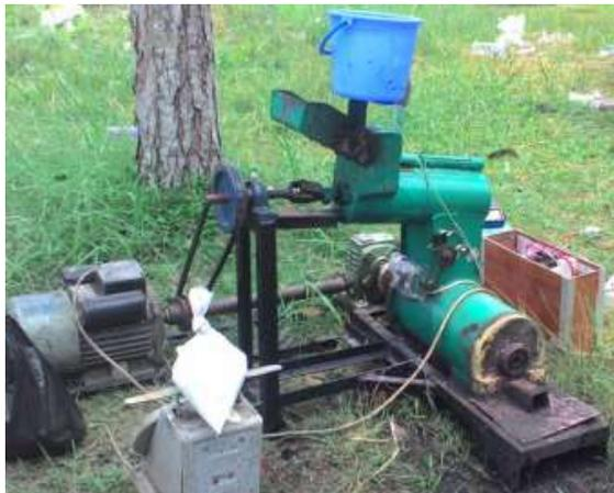
**Gambar 2.** *Prototype* alat pengaduk dan pencetak briket arang kelapa
