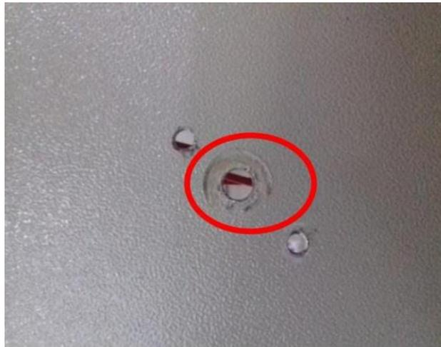
Gambar 2. Cacat lubang panel listrik.
