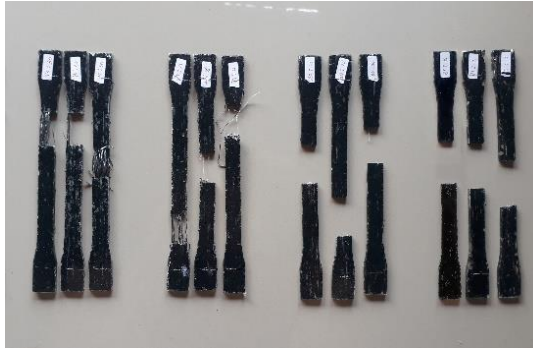
Gambar 2. spesimen setelah diuji tarik
